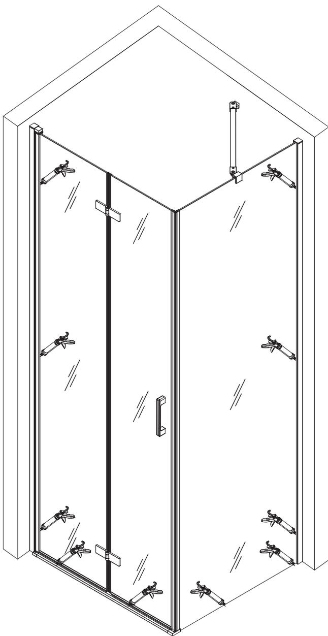
Fixez tous les joints inamovibles à l'aide de silicone sanitaire. Laissez sécher les joints pendant 24 heures.
